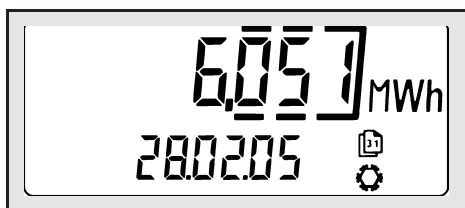
Příklad: měsíční spotřeba energie chladu
